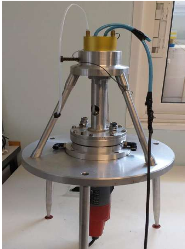
Σχ.231-4 Συσκευή RAM (Rotational Adsorption Machine) που επιτρέπει την ταυτόχρονη μέτρηση ισόθερμης προσρόφησης και περιστροφής του δείγματος.
