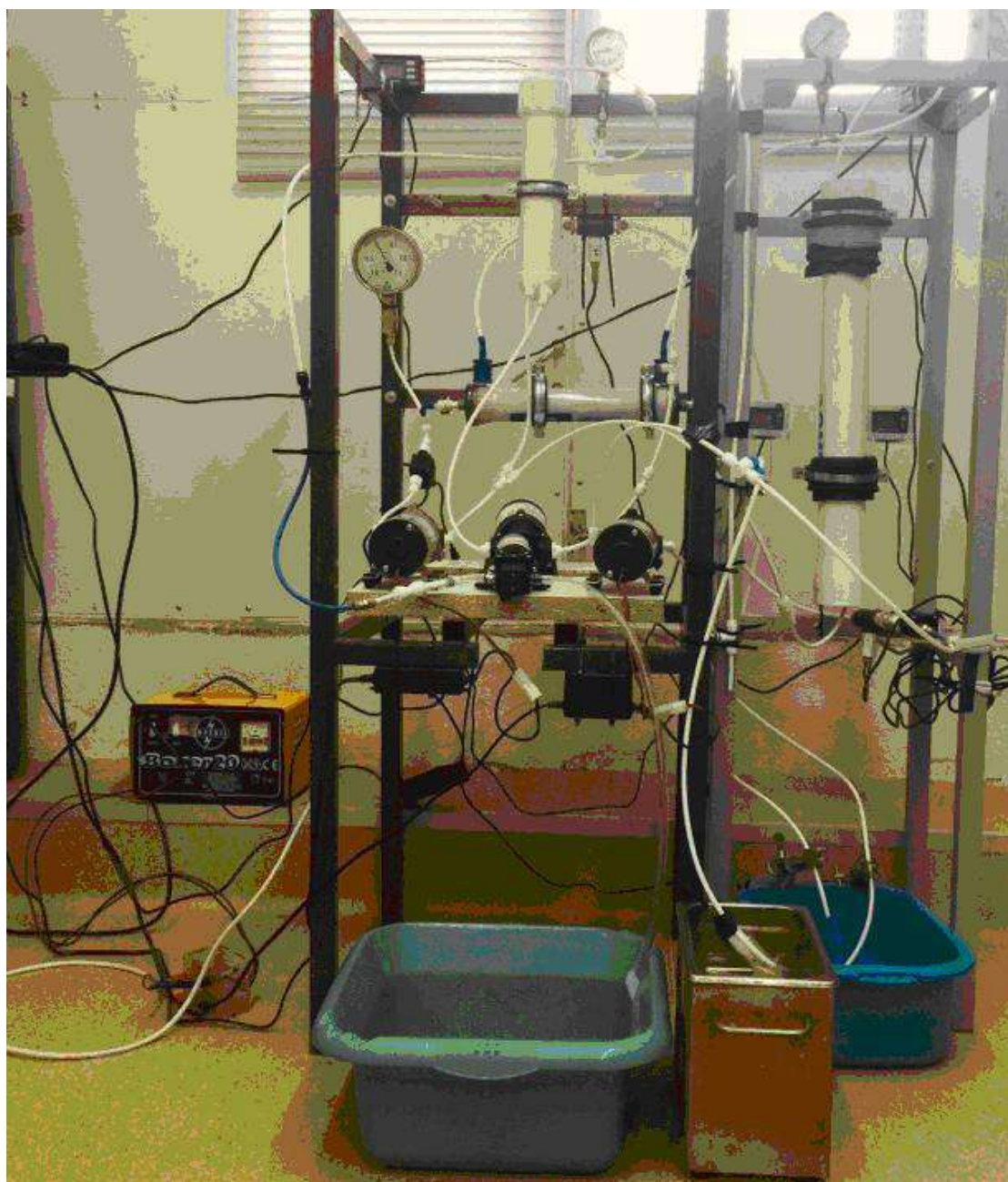
Σχ.346-1 Σύστημα NF-RO-FO
