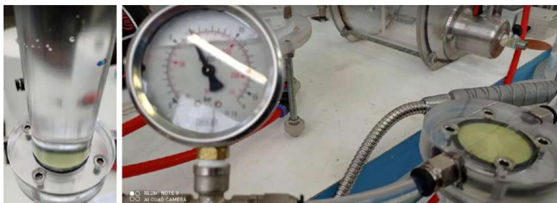
Σχ.213-1 Συσκευή δοκιμασίας μεμβρανών (testing device). Η συσκευή φέρει μεταλλικό υπόστρωμα στήριξης των μεμβρανών, πιεσόμετρο και θερμομέτρο και έχει τη δυνατότητα άσκησης πίεσης μέχρι 6 bar και μεταβολή της θερμοκρασίας του υγρού \Delta\theta .
